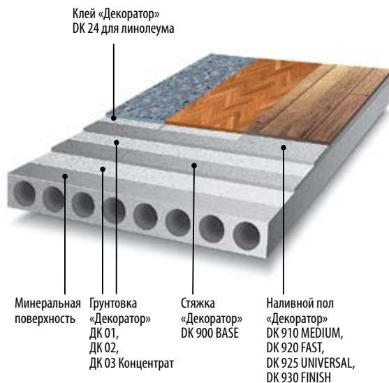
Рис. 2. ВЫРАВНИВАНИЕ ПОЛА ПОД УКЛАДКУ ЛИНОЛЕУМА, ЛАМИНАТА, ПАРКЕТНОЙ ДОСКИ, КОВРОЛИНА
