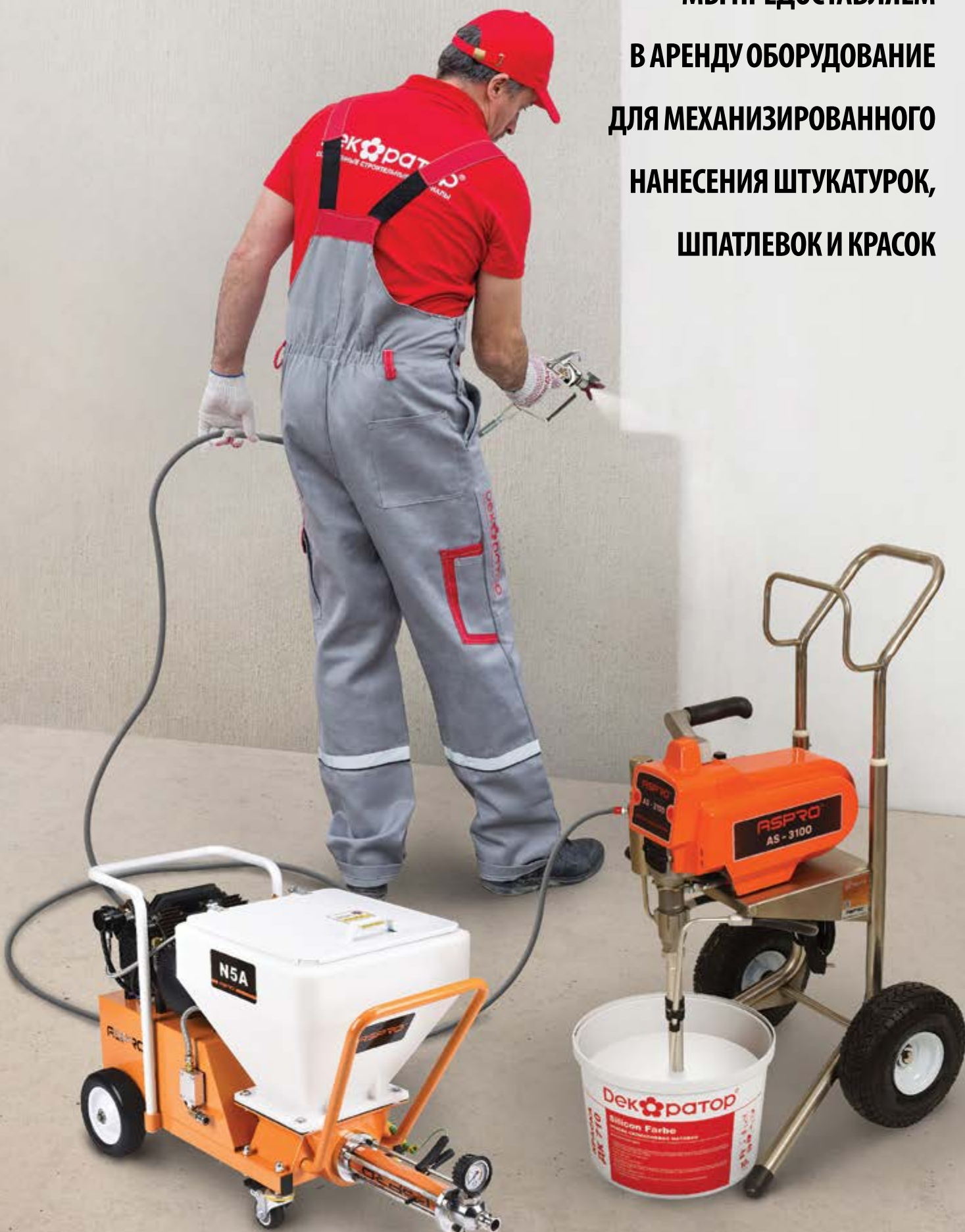
Шпатлевочный агрегат подачи и распыления различных пастообразных составов
